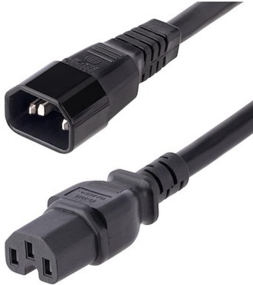
El cable de alimentación (91 cm) C14 a C15 modelo PXTC14C153 incluye un conector C15 apropiado para equipos con funcionamiento a alta temperatura, así como alambre de 2,5 mm<sup>2</sup> apropiado para conexiones de alta potencia: una solución fiable para la conexión con unidades de alimentación (PDU) C14 situadas en entornos con conmutadores de alta tensión y centros de datos, o bien para aplicaciones de servidores grandes que requieren cableado de gran grosor.
