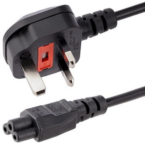
Le cordon d'alimentation de 1 m pour ordinateur portable PXTNB3SUK1M comporte une prise d'alimentation GB (type G) BS 1363 et un connecteur C5 à 3 broches, ce qui en fait un câble de remplacement adéquat pour les ordinateurs portables HP, Toshiba ou d'une autre marque compatible, équipés d'une connexion d'alimentation C5 trèfle.
