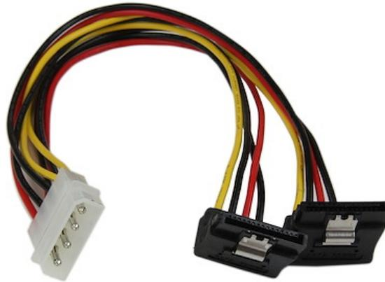
Este cable divisor de alimentación Molex LP4 a Doble SATA de Ángulo Recto con Cierre de Seguridad, PYO2LP4LSATR dispone de dos conectores de alimentación Serial ATA hembra y de un conector LP4 macho – una solución confiable que permite alimentar dos unidades SATA mediante una única conexión LP4 a la fuente de alimentación del computador.
