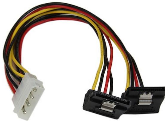
Le câble répartiteur d'alimentation LP4 vers deux SATA à angle droit et verrouillage PYO2LP4LSATR est doté de deux connecteurs d'alimentation Serial ATA femelles et d'un connecteur LP4 mâle. Il offre une solution fiable vous permettant d'alimenter deux disques SATA à l'aide d'une seule connexion LP4 à l'alimentation électrique de l'ordinateur.
