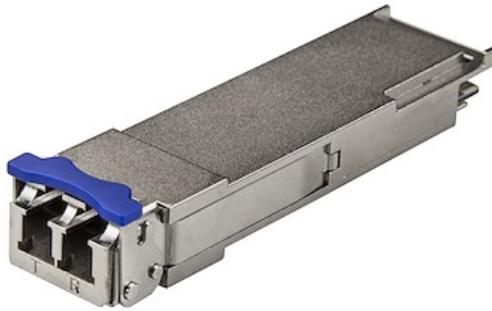
Il QSFP-40G-LR4-AR-ST è un modulo ricetrasmittitore QSFP in fibra compatibile con Arista Networks QSFP-40G-LR4-AR progettato, programmato e testato per funzionare con switch e router prodotti da Arista Networks®. Offre una connettività affidabile 40 GbE su cavo in fibra per le reti compatibili con 40GBASE-LR a una distanza massima di 10 km.
