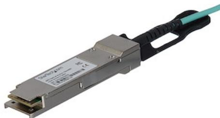
Le modèle QSFP40GAO10M est un câble QSFP+ (Quad Small Form-factor Pluggable) optique conforme aux normes MSA et conçu, programmé et testé pour fonctionner avec les commutateurs et routeurs compatibles 40 GbE. Ce câble optique actif (AOC) QSFP+ prend en charge les applications 40 Gigabit Ethernet (4 x 10 GbE) basées sur des ports QSFP+. Échangeable à chaud, ce câble faible latence et peu énergivore facilite les mises à niveau et les remplacements en minimisant les interruptions sur le réseau.
