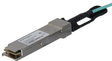
Il prodotto QSFP40GAO30M è un cavo ottico QSFP+ (Quad Small Form Factor Pluggable) conforme a MSA, progettato, programmato e testato per funzionare con switch e router compatibili con 40 GbE. Questo cavo QSFP+ AOC supporta applicazioni Ethernet a 40 Gigabit (4 a 10 GbE) collegate tramite le porte QSFP+. È un cavo a bassa potenza e ridotta latenza, con funzione hot-swap, che consente di eseguire aggiornamenti e sostituzioni senza problemi, riducendo al minimo le interruzioni di rete.
