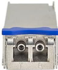
El modelo QSFP40GLR4S es un módulo transceptor por fibra óptica compatible con el modelo QSFP-40G-LR4-S de Cisco, diseñado, programado y probado para su funcionamiento con enrutadores y conmutadores de la marca Cisco®. Ofrece conectividad confiable a 40GbE a través de cableado de fibra, para redes compatibles con 40GBASE-LR4, a una distancia máxima de hasta 10km.
