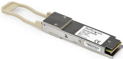
El modelo QSFP40GSR4ES es un módulo transceptor QSFP por fibra óptica compatible con el modelo QSFP-40G-SR4 de Dell EMC diseñado, programado y probado para su funcionamiento con routers y switches de la marca Dell EMC™. Ofrece conectividad confiable a 40 GbE, a través de cable de fibra óptica, para redes compatibles con 40GBASE-SR4, a una distancia máxima de hasta 150 m.
