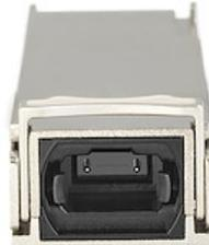
Das QSFP40GSR4ST ist ein Cisco QSFP-40G-SR4-kompatibles Glasfaser-Transceiver-Modul, das speziell für die Zusammenarbeit mit Cisco™-Switches und -Router entwickelt, programmiert und getestet wurde. Es liefert zuverlässige 40-GbE-Konnektivität über Glasfaserkabel für 40GBASE-SR4-konforme Netzwerke mit einer maximalen Entfernung von bis zu 150 m.
