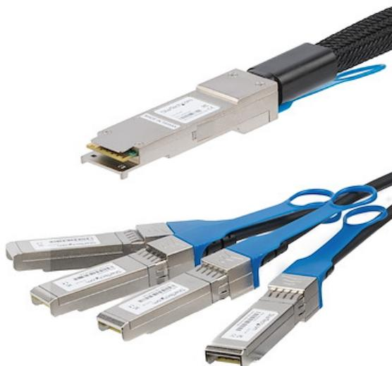
Der QSFP4SFPPC3M ist ein MSA- konformes QSFP+-Twinax-Direktanschlusskabel. Es wurde entwickelt, programmiert und getestet, um 40 G-Netzwerkgeräte mit 10G-kompatiblen Servern oder Routern zu verbinden. Dieses passive Twinaxialkabel verbindet einen einzelnen QSFP+-Anschluss mit vier 10G-SFP+-Anschlüssen und ist vollständig Hot-Plug-fähig, wodurch Upgrades und Austauschvorgänge mit nur minimalen Netzwerkunterbrechungen nahtlos durchgeführt werden können.
