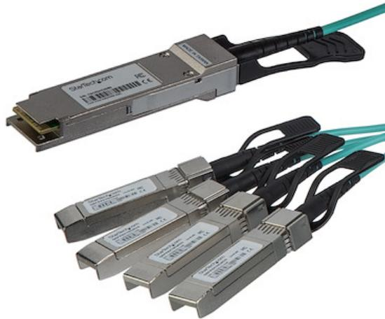
Le modèle QSFP4X10GAO3 est un câble optique répartiteur QSFP+ compatible avec Cisco QSFP-4X10G-AOC3M, qui a été conçu, programmé et testé pour fonctionner avec les commutateurs et routeurs de la marque Cisco®, ainsi que pour respecter les normes MSA. Connectant un port QSFP+ unique (40 GbE) à quatre ports SFP+ 10G, ce câble répartiteur optique actif est échangeable à chaud, ce qui facilite les mises à niveau et les remplacements en minimisant les interruptions sur le réseau.
