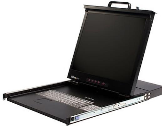
La consola 1U con LCD de 19" para montaje en rack, modelo RACKCONS1908, permite el control centralizado de servidores y conmutadores KVM mediante un conmutador KVM de 8 puertos, un monitor LCD de 19", teclado completo (106 teclas) y panel táctil/ratón, todo combinado en un espacio de 1U de un rack o armario estándar de 30 pulgadas (o más) de profundidad.
