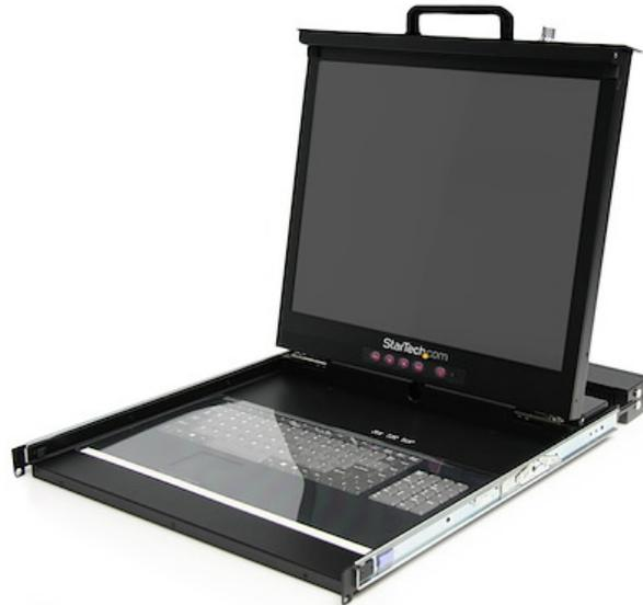
La consola (1U) LCD para montaje en rack, modelo RACKCONS1916, incluye un módulo integrado de conmutador KVM multiplataforma de 16 puertos, monitor LCD de matriz activa de 19 pulgadas, teclado con 106 teclas y panel táctil/ratón, todo combinado en un espacio de 1U de un rack o armario estándar de 30 pulgadas (o más) de profundidad.
