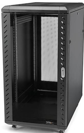
Questo rack per server offre 32U di spazio in un armadietto elegante e protetto per l'installazione di dispositivi da 19"; conformi allo standard EIA-310 montabili su rack, quali i server Dell, HP e IBM, oltre ad altre apparecchiature di telecomunicazione e A/V. Soluzione altamente robusta, il rack supporta una capacità di carico totale pari a 800 kg .
