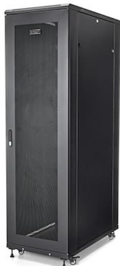
Dieser 42HE-Serverschrank bietet sicheren Stauraum für EIA-310-konforme 19"-Geräte wie Dell-, HP- und IBM-Server sowie Telekommunikations- und A/V-Geräte. Der Serverschrank ist eine kostengünstige und dennoch robuste Lösung mit einer Tragkraft von insgesamt 907 kg.
