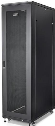
Este armario rack para servidores 42U proporciona un espacio de almacenamiento seguro para guardar dispositivos de montaje en rack de 19" compatibles con EIA-310, como servidores Dell, HP e IBM, así como equipos de telecomunicaciones y A/V. El rack para servidores ofrece una solución económica a la vez que robusta, con una capacidad de carga total de 907 kg.
