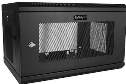
Este armario rack para servidores 6U le permite montar su equipo compatible con EIA-310 en la pared. El armario cuenta con una profundidad de montaje de hasta 15in(38cm) y ofrece una capacidad de carga máxima de 90kg.
