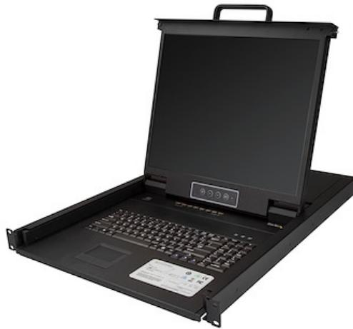
Diese KVM-Konsole für die Rackmontage bietet vollständige Steuerung über Tastatur, Monitor und Maus für acht Computer. Die Rack-Konsole wird in 1 HE eines Racks Platz und stellt eine platzsparende Lösung für eine vollständige Konsolensteuerung dar.
