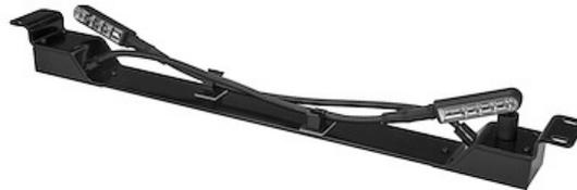
Diese 1HE-Rack-Lichtleiste kann in jeden EIA-310-kompatiblen Schrank installiert werden und ermöglicht Ihnen, Arbeiten in Ihrem Server-Rack durchzuführen, die Beleuchtung erfordern. Die Leiste kann in jedem 19-Zoll-Standard-Rack mit einer Höheneinheit montiert werden und verfügt über zwei einstellbare 432 mm lange Schwanenhalsleuchten. Zur einfachen Installation enthält die Lichtleiste außerdem ein 1,5 m langes Netzkabel, das leicht an eine in Ihrem Rack montierte PDU angeschlossen werden kann.
