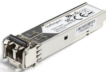
El modelo RXFXSMSFPST es un módulo transceptor SFP por fibra óptica compatible con el modelo RX-FXSM-SFP de Juniper diseñado, programado y probado para su funcionamiento con routers y switches de la marca Juniper®. Ofrece conectividad fiable a 100 MbE, a través de cable de fibra óptica, para redes compatibles con 100BASE-LX10, a una distancia máxima de hasta 10 km.
