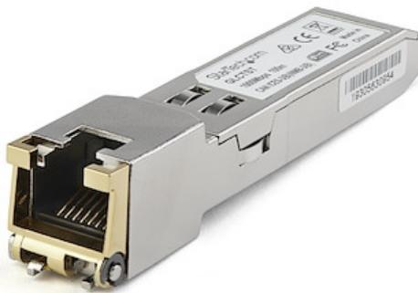
El modelo RXGETSFPST es un módulo transceptor SFP por fibra óptica compatible con el modelo SFP-100M-FX de Dell EMC diseñado, programado y probado para su funcionamiento con routers y switches de la marca Dell EMC™. Ofrece conectividad fiable a 1 GbE, a través de cable de fibra óptica, para redes compatibles con 1000BASE-T, a una distancia máxima de hasta 100 m.
