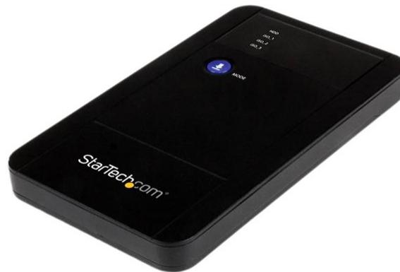
ISO-Laufwerkemulation ist eine ideale Lösung für Computer ohne optische Laufwerke (z. B. Ultrabooks™, Netbooks). Durch Verwendung von hardwaregestützter ISO-Emulation ermöglicht das USB 3.0-HDD Virtual ISO-Gehäuse S2510BU3ISO, bis zu 3 verschiedene virtuelle Blu-ray/DVD/CD-ROM-Abbilder zu erstellen und zu montieren. So kann maximale Leistung ohne den Aufwand und die Kosten von komplizierter virtueller ISO-Software erzielt werden.
