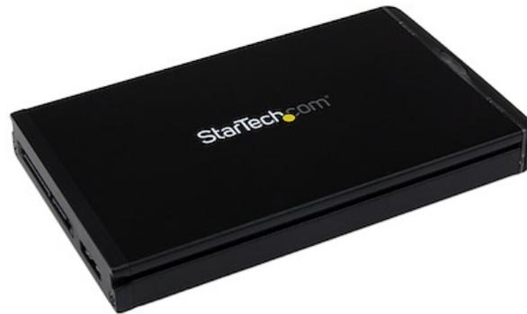
Este gabinete de unidad de disco duro USB 3.1 (10Gbps) sirve de gabinete extra para un disco duro SATA utilizado con la bahía de intercambio en caliente para unidad SATA SSD / DD de 2.5" modelo S251BU31REM de StarTech.com.
