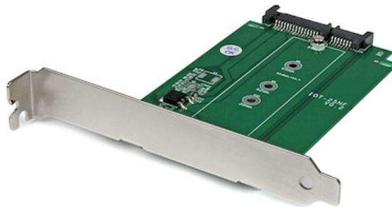
El adaptador M.2 a SATA, modelo S32M2NGFFPEX, permite conectar una unidad SSD SATA M.2 (NGFF) a un puerto SATA estándar, así como el montaje de la unidad en cualquier ranura de expansión de un PC de sobremesa.
