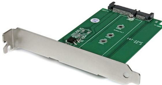
M.2 – SATAアダプタ。SATA M.2(NGFF)SSDを標準SATAポートに接続し、ドライブをデスクトップPCの拡張スロットにマウントします。
