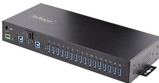
El hub USB industrial de 16 puertos a 5 Gbps con adaptador de corriente cuenta con 16 puertos USB-A de bajada. Su robusta construcción totalmente metálica es adecuada para su uso en aplicaciones industriales de montaje en bastidor. La protección contra descargas electrostáticas (ESD) de nivel 4 protege contra descargas de 15 kV por aire / 8 kV por contacto. El concentrador cuenta con un conmutador de host de 2 puertos, que permite a los usuarios conmutar entre dos dispositivos host.
