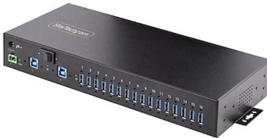
L'hub industriale USB 5Gbps a 16 porte con adattatore di alimentazione è dotato di 16 porte USB-A downstream. La robusta struttura interamente in metallo è adatta all'uso in applicazioni industriali a rack. La protezione ESD (Electrostatic Discharge) di livello 4 protegge da scariche di 15kV in aria e 8kV a contatto. L'hub è dotato di uno switch host a 2 porte che consente agli utenti di passare da un dispositivo host all'altro.
