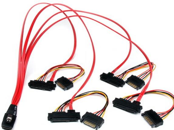
El cable Mini SAS a SAS (50 cm), SAS808782P50 dispone de un conector de 36 pines SFF-8087 que se abre en cuatro receptáculos SFF-8482 individuales de 29 pines proporcionando una solución fiable para conectar múltiples discos duros SAS (con datos y alimentación) a una sola conexión del controlador mini SAS.
