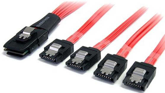
Das SFF-8087-auf-4x SATA-SAS-Kabel SAS8087S4100 verfügt über eine 36-polige Aufnahme (SFF-8087), die sich in vier 7-polige SATA-Aufnahmen auffächert und eine zuverlässige Lösung zum Anschließen einer SATA-Festplatte an einem SAS-Controller oder Backplane bietet.
