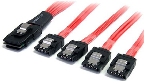
El cable SAS SFF-8087 a 4x SATA, SAS8087S4100 dispone de un conector de 36 pines (SFF-8087) que se abre en cuatro conectores SATA de 7 pines proporcionando una solución fiable para conectar un disco duro SATA a un controlador o backplane SAS.
