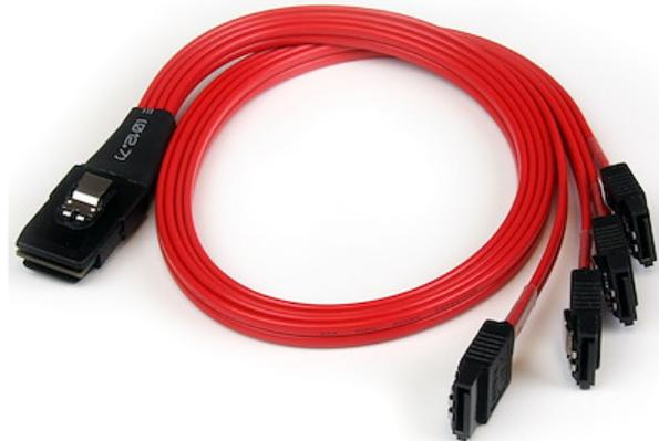
Das SFF-8087-auf-4x SATA Reverse-Kabel SAS8087S4R50 verfügt über eine 36-polige Aufnahme (SFF-8087), die sich in vier 7-polige SATA-Aufnahmen auffächert und eine zuverlässige Lösung zum Anschließen eines Mini SAS-Backplane an einen SAS/SATA RAID-Controller oder eine Hauptplatine bietet.
