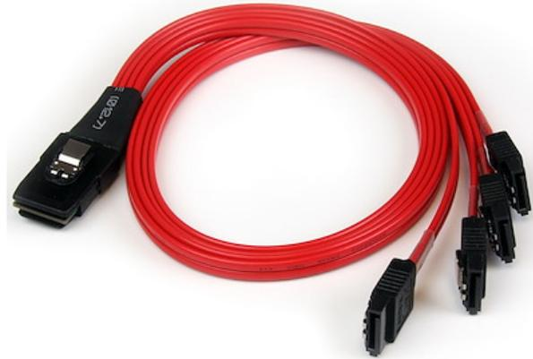
Il cavo invertitore SAS8087S4R50 SFF-8087 a SATA 4x presenta una spina a 36 pin (SFF-8087) che si dirama in quattro connettori SATA a 7 pin, offrendo una soluzione affidabile per il collegamento di backplane Mini SAS a una scheda madre o un controller SAS/SATA RAID
