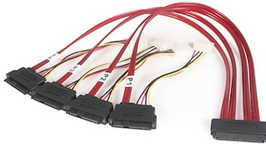
El cable SAS SAS8482P50 SFF-8484 a 4 SFF-8482 incluye un receptáculo de 32 pines (SFF-8484) que se extiende a cuatro receptáculos SFF-8482 de 29 pines, con cuatro conectores de alimentación LP4, lo cual constituye una solución fiable para conectar hasta cuatro discos duros SAS HDD a un backplane o controlador SAS.
