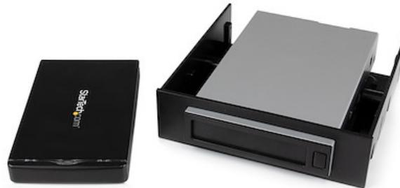
Il sistema per backup di HDD SATA 2,5" rimovibile/rack trasportabile SAT2510U3REM trasforma un'unità HDD/SSD SATA 2,5" in un disco rigido rimovibile che può essere utilizzato esternamente come un normale box USB 3.0.
