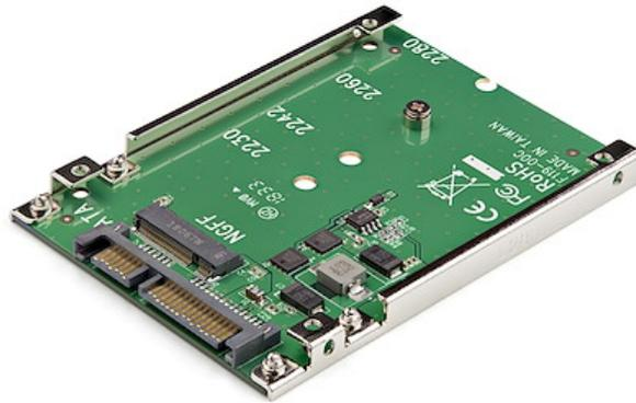
Adattatore SSD SATA M.2 a SATA da 2,5" che integra la velocità di un'unità SSD SATA M.2 nelle applicazioni con unità SATA da 2,5" per un aumento esponenziale delle prestazioni del sistema.
