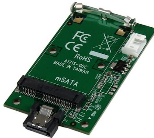
SATA – mSATA変換アダプタ。mSATA SSDを標準SATAポートに接続できるようにします。mSATAポートを搭載していないITXコンピュータシステムにmSATA SSDを接続できるソリューションです。
