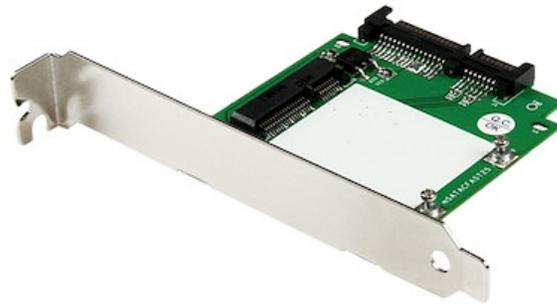
L'adattatore mSATA a SATA SAT32MSATPEX permette di collegare un'unità SSD mSATA a una porta SATA standard e montare l'unità nello slot di espansione di qualsiasi desktop.
