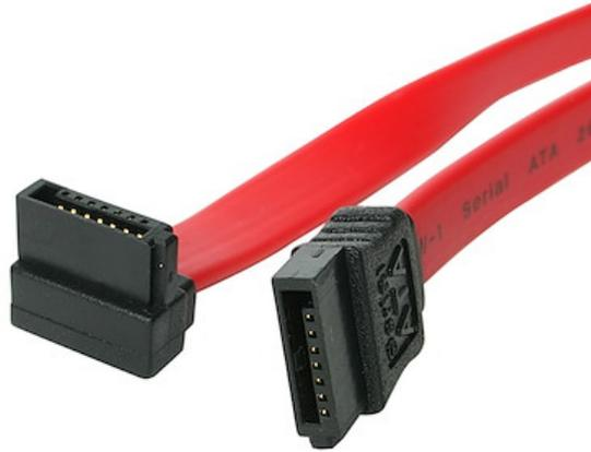
片側がL字型(下向き)コネクタのSATAケーブル。一方は標準(ストレート)コネクタになっており、シリアルATAドライブと45cmの長さでシンプルに接続します。SATA 3.0準拠ドライブで使用する際、SATA 3.0の最大転送速度6Gbpsに対応します。
