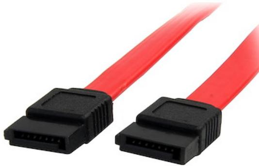
El cable serial ATA SATA24 incluye dos receptáculos para datos, de 7 pines, y soporta completamente el ancho de banda SATA 3.0 de hasta 6 Gpbs cuando se utiliza con unidades SATA 3.0 compatibles.
