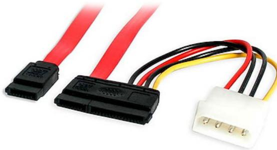
Il cavo dati e di alimentazione SATA SATA24POW presenta un connettore dati e di alimentazione SATA combinato da 22 pin oltre a un connettore di alimentazione Molex (LP4) e un connettore dati SATA che consentono di creare una normale connessione dati ATA seriale a un computer alimentando al contempo l'unità attraverso una connessione LP4 all'alimentatore del computer.
