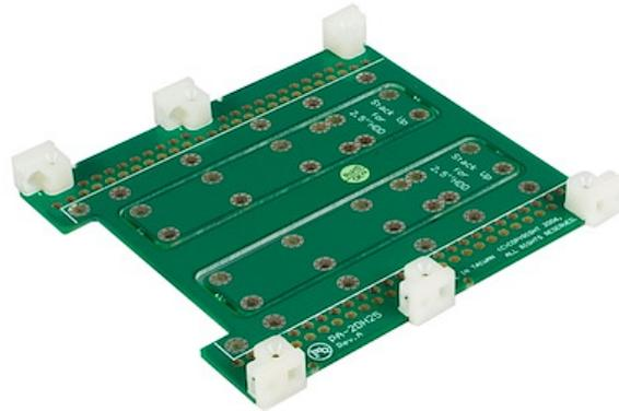
Este Adaptador para Disco Duro SATA permite instalar uno o dos discos duros (HDD) o unidades de estado sólido (SSD) SATA (SATA, SATA II, SATA III) de 2,5 pulgadas en una bahía de 3,5 pulgadas y conectarla al ordenador host en el lugar del disco duro de 3,5 pulgadas.
