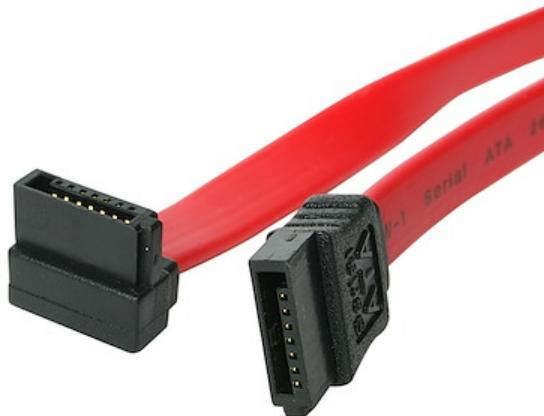
片側がL字型(右向き90度)コネクタのSATAケーブル(91cm)。一方は標準(ストレート)SATAコネクタになっており、シリアルATAドライブと接続します。SATA 3.0準拠ドライブで使用する際、SATA 3.0の最大転送速度6Gbpsに対応します。
