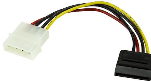
パリアフェラル電源オスコネクタ(4ピン)をSATA電源コネクタ(メス)に変換するアダプタ。従来型のパリアフェラル電源コネクタからSATAハードドライブに給電できるため、SATAハードドライブと互換性を持たせるために電源をアップグレードする必要がありません。
