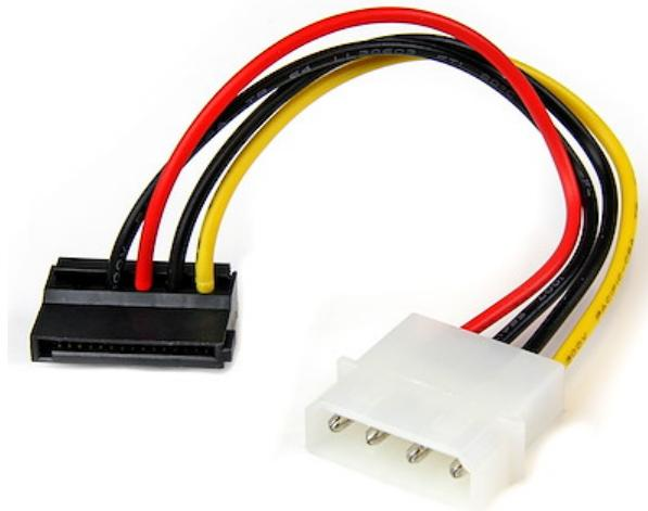
El adaptador para LP4 a alimentación SATA a 90 grados SATAPOWADPL incluye un conector Molex (LP4) macho de 4 pines y un conector (hembra) de alimentación SATA a 90 grados, en ángulo izquierdo, lo cual permite la alimentación de una unidad de disco duro serial ATA a partir de una conexión LP4 convencional, y evita gastar en actualizar el ordenador a un modelo con compatibilidad con los discos duros SATA.
