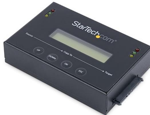
El duplicador independiente de disco duro SATDUP11 permite copiar discos duros 1 a 1 o bien borrar hasta 2 discos duros SATA simultáneamente, sin un computador anfitrión.
