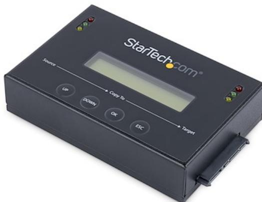
Il duplicatore di dischi rigidi standalone SATDUP11 consente di copiare da 1 a 1 o di cancellare fino a 2 dischi rigidi SATA simultaneamente senza l'ausilio di un computer.
