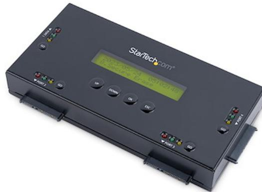
Este borrador autónomo de unidades de disco borra simultáneamente hasta cuatro unidades de disco duro o de estado sólido SATA de 2,5" o 3,5".
