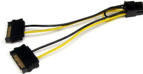
Le câble adaptateur d'alimentation SATA vers PCI Express pour carte vidéo SATPCIEXADAP est équipé d'un connecteur d'alimentation PCI Express à 6 broches (mâle) ainsi que de deux connecteurs d'alimentation SATA à 15 broches (mâles), offrant une solution économique pour connecter une carte vidéo PCIe aux connecteurs d'alimentation Serial ATA fournis par l'alimentation de l'ordinateur. Cela élimine la nécessité de mettre à niveau l'alimentation pour des raisons de compatibilité avec la carte vidéo.
