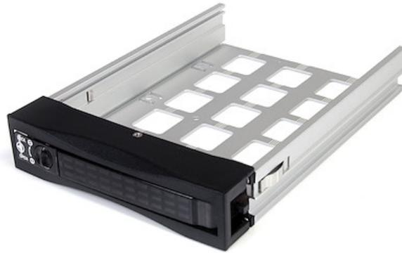
Le tiroir à échange à chaud pour disque dur SATSASTRAYBK a été spécialement conçu comme un tiroir pour disque dur SATA/SAS 2,5/3,5 pouces supplémentaire pour le modèle SATSASBAY3BK (face arrière à échange à chaud pour 3 disques SATA/SAS), vous permettant d'utiliser des disques durs de rechange en plus de ceux qui sont installés sur la face arrière/le rack mobile.
